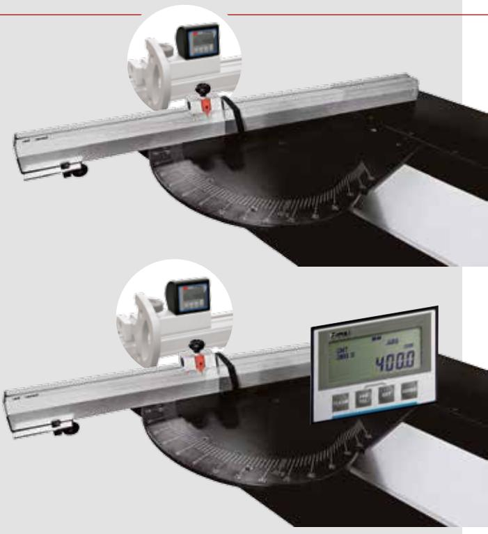
I A richiesta verrà fornito un pratico pianetto per tagli angolati rimovibile, con lettura meccanica con angolazioni +/- 50° ed estensione fino a 2400 mm. A richiesta possono essere forniti visore digitale dell'angolazione della guida e/o coppia di stop digitali per una più facile lettura delle quote.
