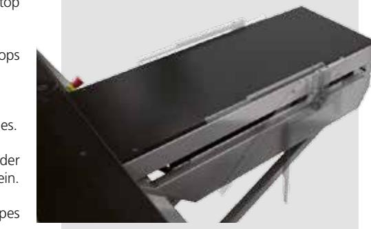
F Le guide arrière motorisé et programmable double butée tournante (**space saving System**), grâce à son système innovant, fonctionne de façon autonome quels de deux de butée on peut utiliser selon la demande de mesure. La distance entre les deux butées de 420 mm permet d'avoir un support valable pour les coupes parallèles.
